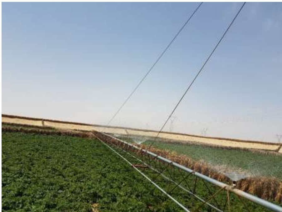
Photo 1. Pivot artisanal de fabrication locale irrigant un champ de pomme de terre. Commune de Hassi Khalifa, wilaya d'El Oued (source : auteurs, 2018)
