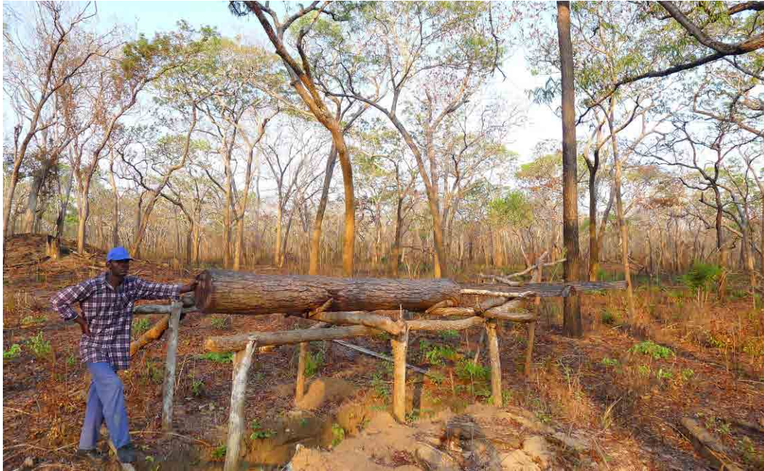
Ilustração 6 Um tronco de “Umbila” ( Pterocarpus anoglensis ) pronto para serrar a mão. (S 11°13,195', E 40°00,109', A 150m)
