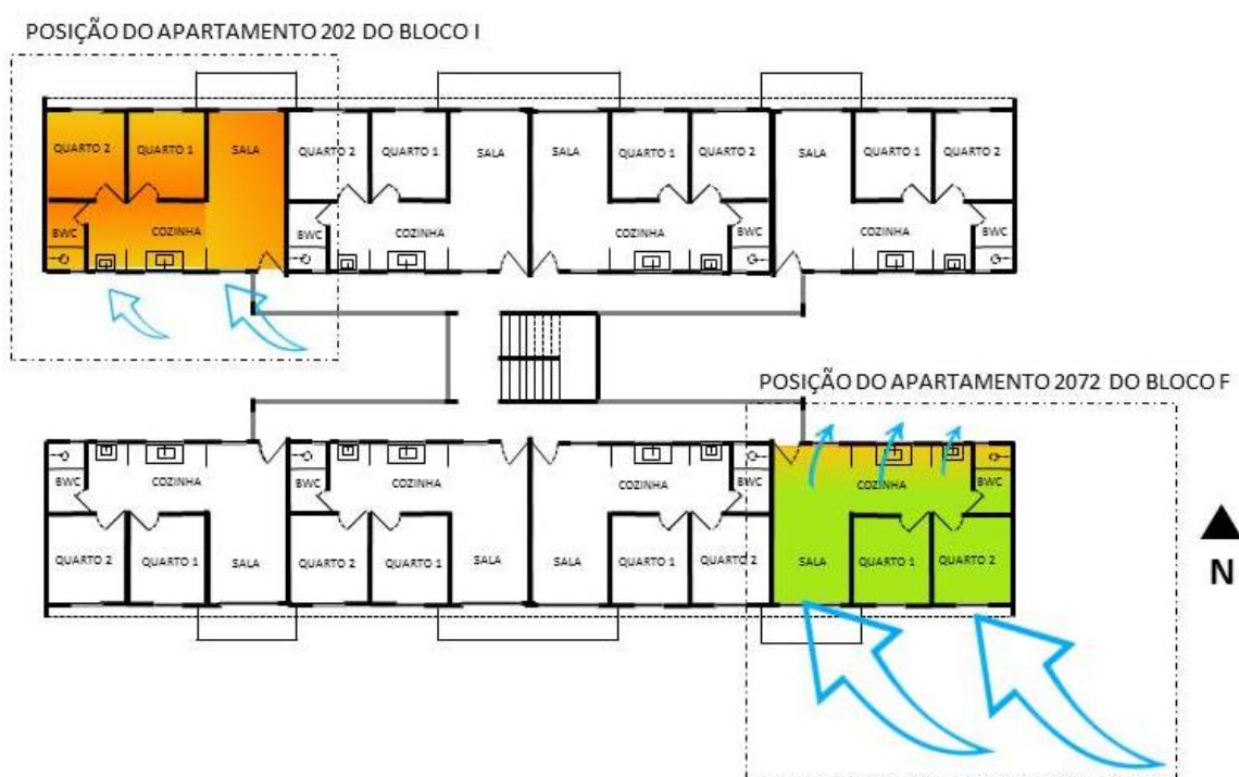
Figura 67: Condições térmicas nos apartamentos 202 do bloco I e 207 do bloco F.
